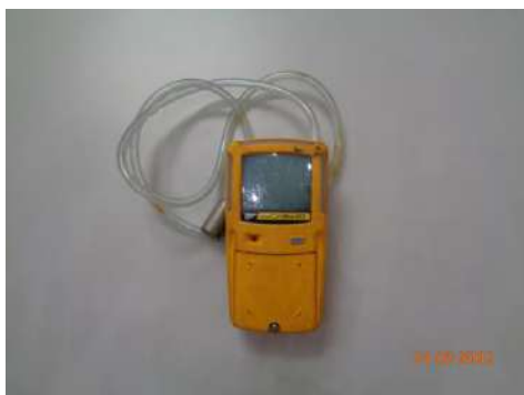
ภาพที่ 2.2-39 เครื่องตรวจจับก๊าซ
